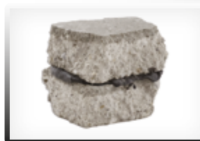
Przykład spoiny wykonanej pod wodą
